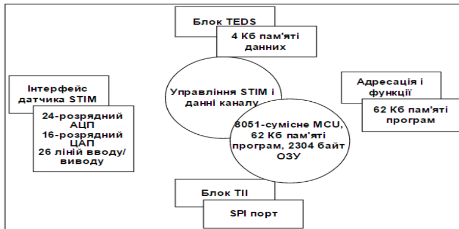
Рис.1. Реалізація стандарту IEEE 1451 на архітектурі ADuC847
